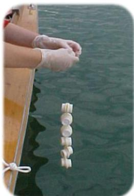
Les échantillonneurs intégratifs passifs (EIP) permettent la surveillance de la qualité chimique des milieux aquatiques. La technique du gradient de diffusion en couche mince (diffusive gradient in thin film, DGT) est utilisée pour la mesure des métaux.
